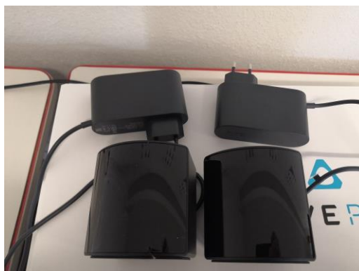
Figure 4 Capteurs du système (stations) avec leur alimentation
